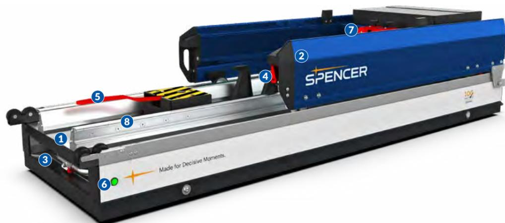
**1** Struttura in alluminio e piatto superiore in acciaio inox. **2** Binario estraibile per facilitare l'aggancio tra la barella e il supporto. **3** Vano di alloggiamento per tavola spinale o barella cucchiaino. **4** Leva laterale destra per far rientrare il binario estraibile. **5** Leva di sblocco semiautomatico per liberare la barella. **6** Il LED verde
