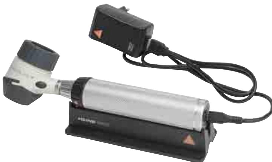
HEINE DELTA 20 T consente l'analisi dermatoscopica per la diagnosi precoce di melanomi maligni, di lesioni non melanocitarie, carcinomi basocellulari e dermatofibromi mediante esami con liquido di immersione e con luce polarizzata. Semplicemente premendo un tasto sulla testina, è possibile commutare da visualizzazione polarizzata a non polarizzata, senza sostituire la piastrina di contatto.
