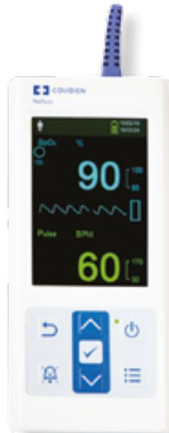
Modello palmare, leggero ed ergonomico per il monitoraggio continuo ed istantaneo della saturazione ematica di ossigeno e della frequenza cardiaca
