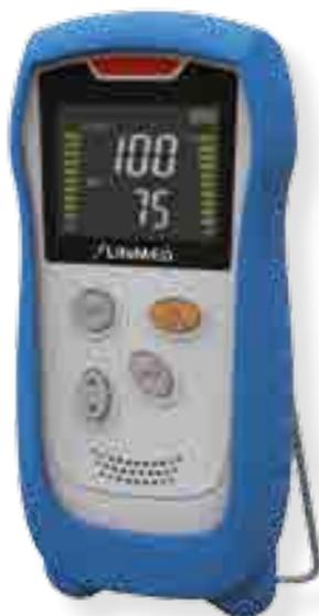
Strumento portatile per la rilevazione della quantità di ossigeno legata all'emoglobina nel sangue e della frequenza cardiaca in modo non invasivo.
