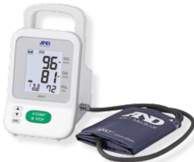
Misuratore professionale che coniuga la misurazione automatica oscillometrica con la rilevazione auscultatoria, effettuata dal medico o dal personale infermieristico, con lo stetoscopio tradizionale (opzionale).
